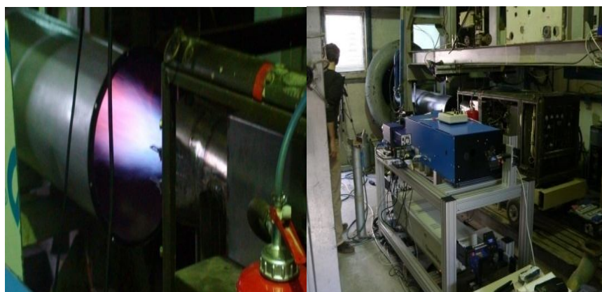
Fig. 3.20 - Amenajarea experimentală - postcombustia în timpul funcționării (în stânga) și instalația laser LIF în timpul calibrării (în dreapta)
